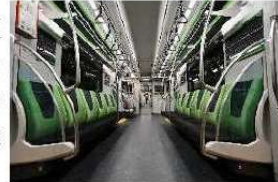
日暮里・舎人ライナーで実施した車両のロングシート化 出典：東京都交通局 HP
