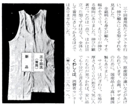
型くずれ 三十回着用したテストを行つたランニングショーツ。洗濯頻度は多いから、型くずれ、縮み、色あせ、生地が硬くなるなど、品質の良さが買つ時のポイントになります。
