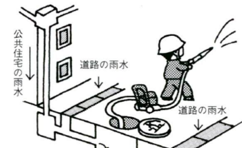
貯留水路 不要になった水路を生かし、貯水タンクを設置し、大雨のときに雨水を一時的にためて、下水道への流出量を抑制します(一時貯留水路)。また、常時水をためておき消火用水などにも利用します(多目的貯留水路)
