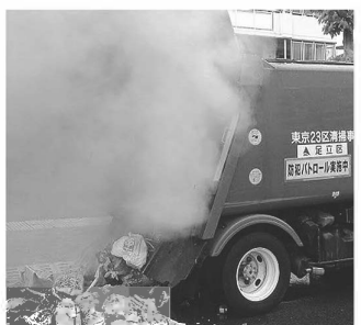
▲スプレー缶などが原因で火災が発生したごみ収集車
