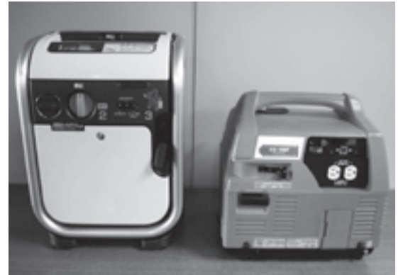
▲ 停電時でもガスボンベを使って発電ができる
