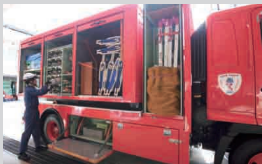
資材搬送車 …通常はポンプ隊として活動し、災害時には現場へ大量の消防器材を搬送
