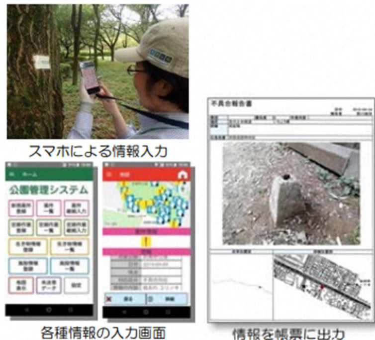
図 適切な維持管理を行うための取組「パークモニタリングシステム」
