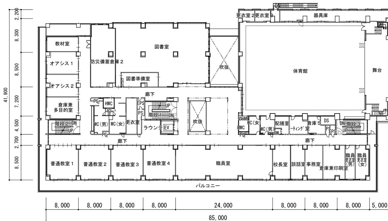
●建物中央の吹抜を囲むように廊下及び各室を配置し、明るく風通しの良い建物計画とします。
