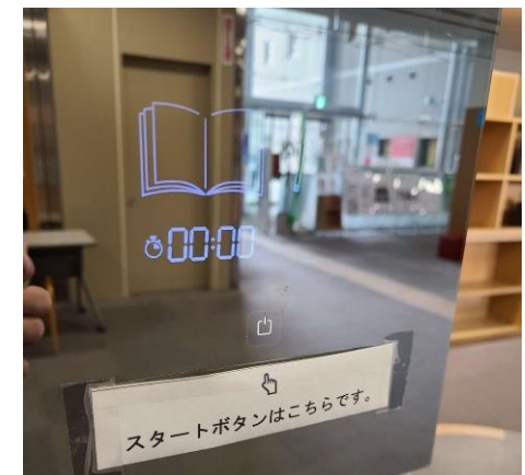
③ ドアを閉め、右上にあるスタートボタンを押します（タイマーに作業完了までの時間が表示されます）。
