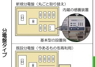
増設型の 感震装置 感震装置内蔵の基本型や、既設分電盤のとなりに設置する増設型(後付けタイプ)などがあります。
