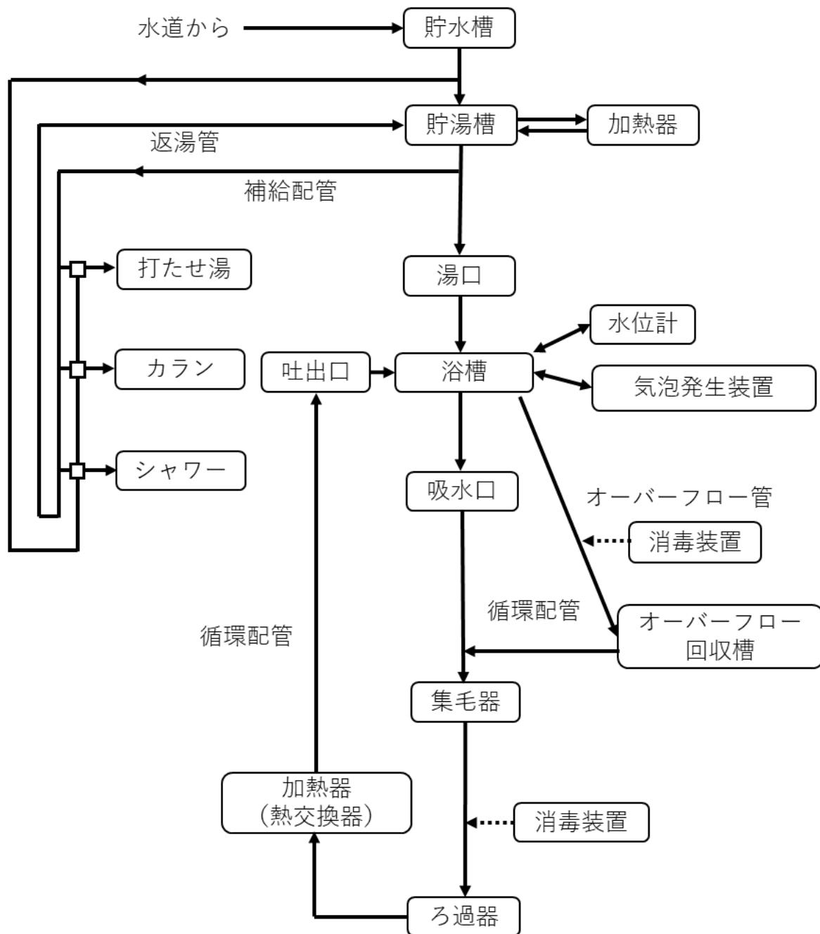
配管図等の図面を参照しながらチームで現場確認を行った後に作成する簡略図（流れ図）の例を示します。簡略図を作成すると施設の状況が把握しやすくなり、3) レジオネラ属菌が増殖、拡散しうる設備・箇所の特定以降で使用することもできます。この図は循環式浴槽の例を示しています。ここで示す図は書き方の例ですので、それぞれの入浴施設の設備の設置状況に合わせて図を作成してください。
