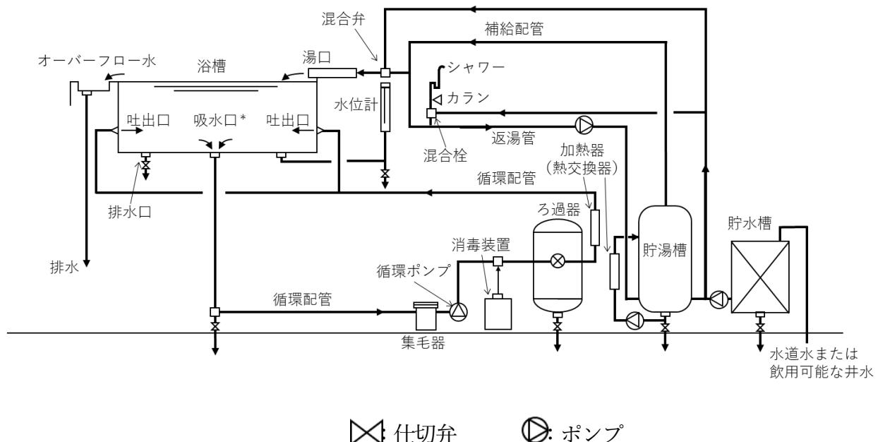
この図は温泉を原水とする循環式浴槽施設の概要の例です。点線は設置している場合となる場合があることを示しています。
