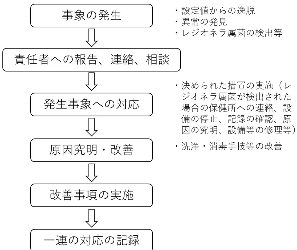
貯湯槽水の温度や浴槽水の遊離残留塩素濃度などの予め設定した温度や濃度（基準値）から逸脱した場合、あるいは生物膜が形成された、レジオネラ属菌の増殖が明らかになった場合等の逸脱が発生した場合の措置を決めておきます。対応の流れの概要の例を図に示します。
