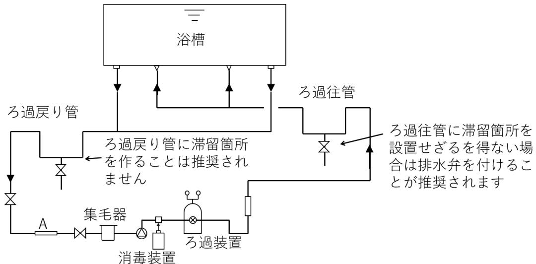
水を循環可能な水位まで減らし、循環配管などの材質の腐食を考慮して5～10 mg/L の遊離残留塩素濃度<sup>注)</sup>で数時間循環させた後、必要に応じてチオ硫酸ナトリウムで遊離残留塩素濃度を下げて排水します。この操作を換水の都度行うことで、循環配管への生物膜の蓄積を防止することができます。循環配管洗浄の際は、水位計配管や連通管も同時にを行うようにしてください。詳細はII-12. 水位計及び水位計配管及びII-13. 連通管の項を参照ください。
