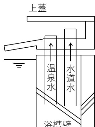
ように湯口内に別々の配管とし、水道水を上流側にします。内部は上蓋を外して洗浄・消毒します。
