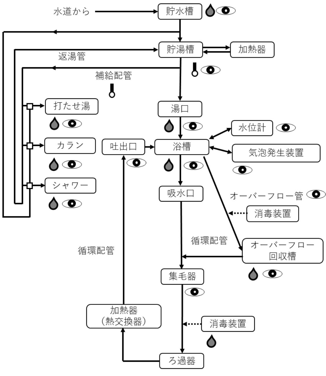
◆ : 塩素濃度測定      ◇ : 温度測定      ● : 目視観察（綿棒採取を含む）
