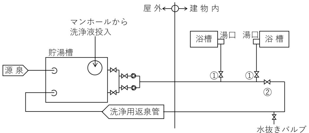
貯湯槽に薬剤を投入し、ポンプによる循環洗浄を行います。
