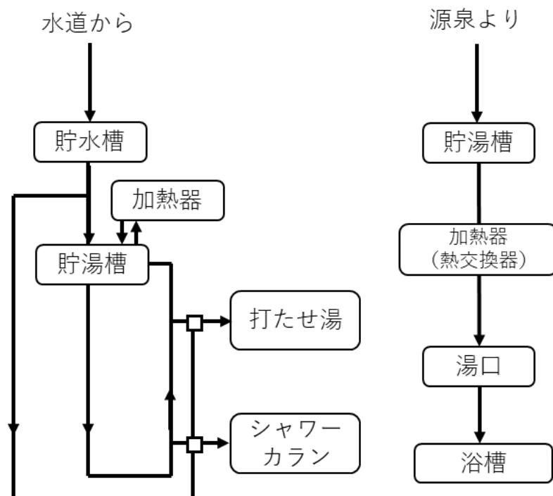
この図ではかけ流し式浴槽の簡略図（流れ図）の例を示しています。加熱装置を除く、消毒装置を書き加えるなど、施設の状況により図を作成します。
