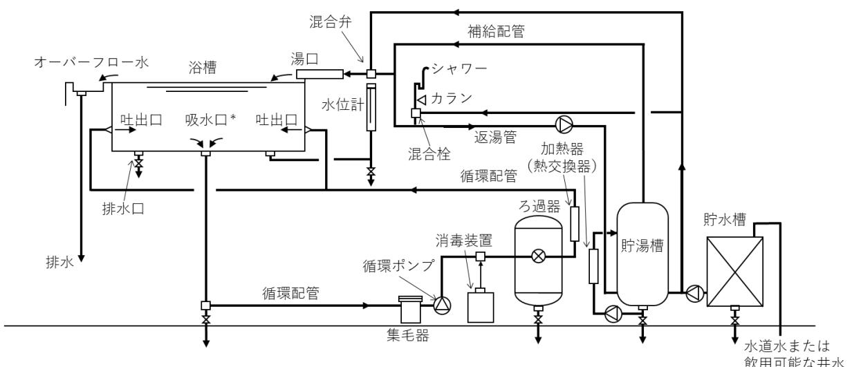
これは循環式浴槽の概要図の 1 例ですが、流れ図に代えてこのような図を用いることもあります。
