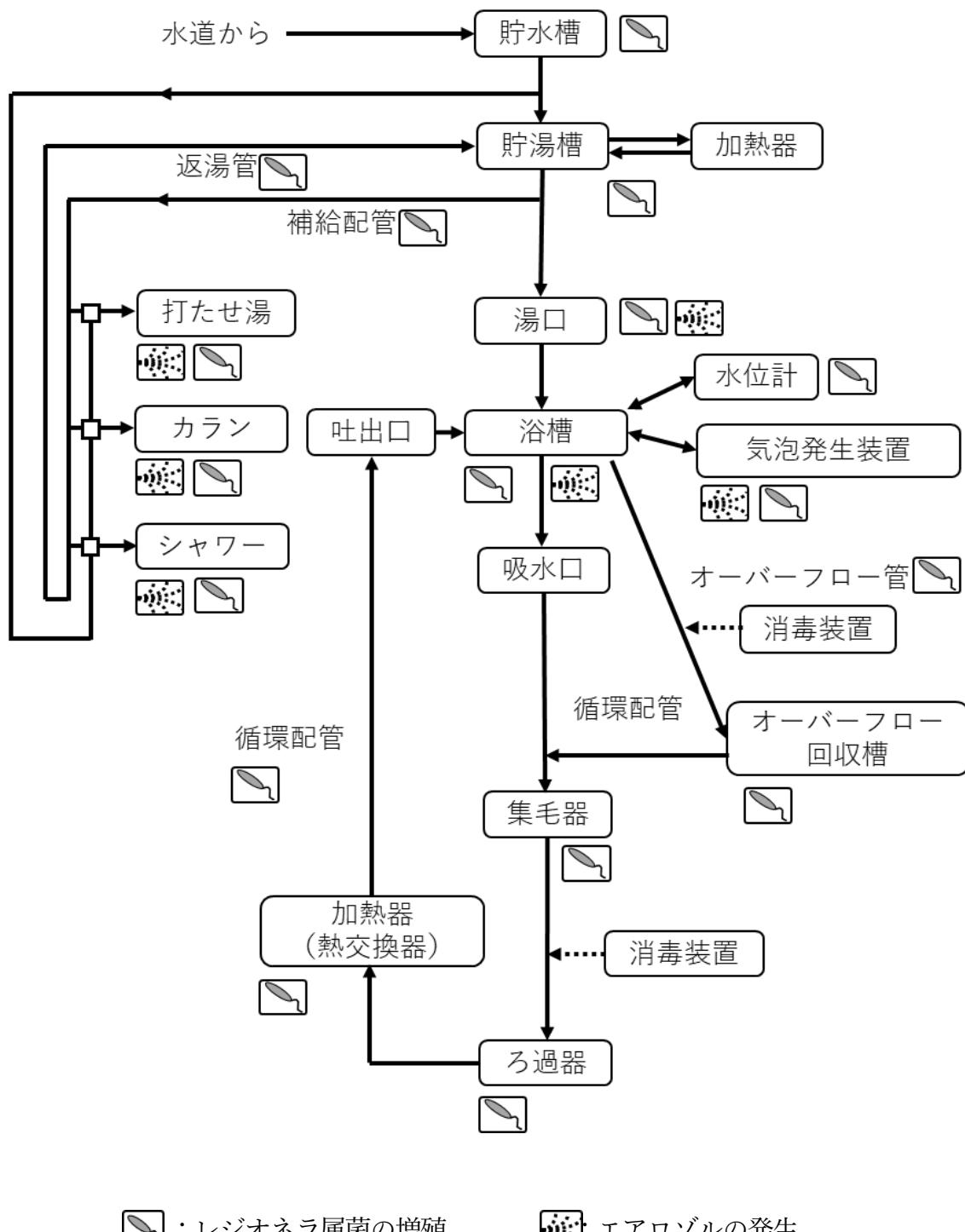
2) 施設・設備の確認で作成した配管の簡略図を利用して、レジオネラ属菌が増殖する可能性がある設備やエアロゾルが発生しやすい箇所を特定します。循環式浴槽の例を示しています。この図は1例ですので、設備の状況等に応じて適宜リスクのある場所を特定してください。
