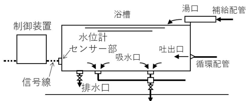
やむを得ず水位計配管を設ける場合は、水位計ができるだけ浴槽に近付けて配管を短くし、浴槽側に下り勾配を設けて、浴槽換水時に完全に排水できるようにし、内部を洗浄・消毒できる構造にします。配管に立ち上がりの部分がある場合は滞留しやすいため、水抜きを設けて排水と洗浄・消毒がしやすい構造とします。
