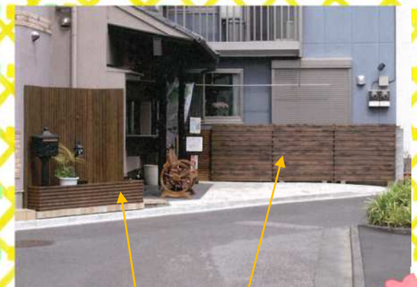
エコ機能ウォール（雨水タンクを内蔵し、国産木材・間伐材を利用（平成27年度助成））
