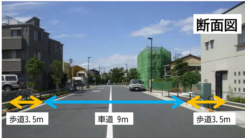
上空には電線がなくスッキリした広い道路 (補助第138号線 梅田地区)
