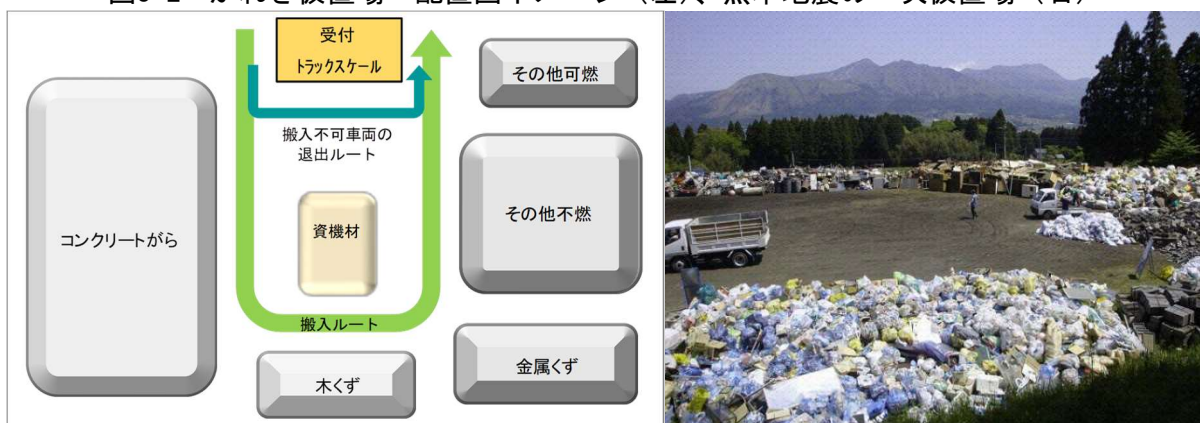
図3-2 がれき仮置場 配置図イメージ（左）、熊本地震の一次仮置場（右）
