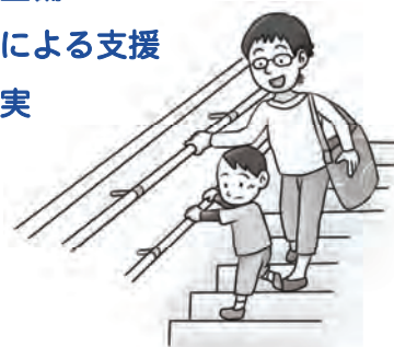
2つの高さに設置された手すり
