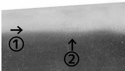
刃紋画像 ①匂(におい) … 境目の白くぼやけた部分 ②沸(にえ) … 細かい帯状の粒の部分 (見やすいよう画像処理をしています)
