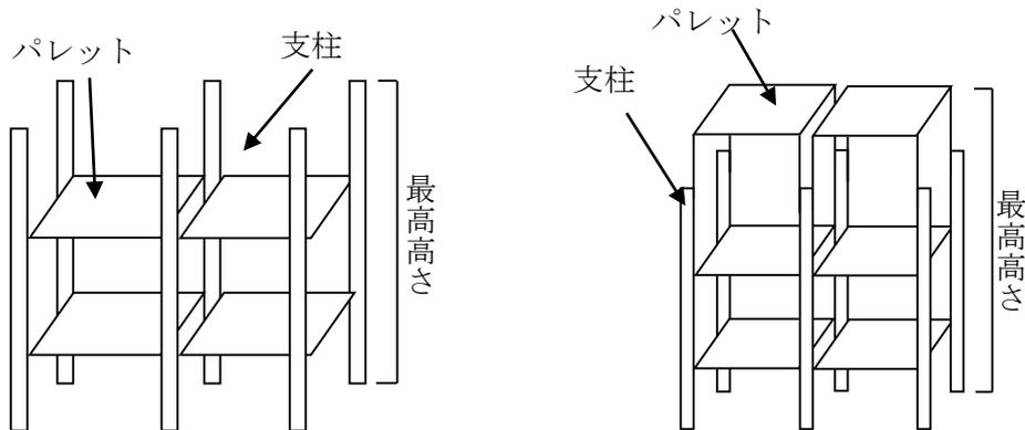
※吊下げ機械式駐車場の場合は設置面を GL として高さ算定をする（右下図）。
