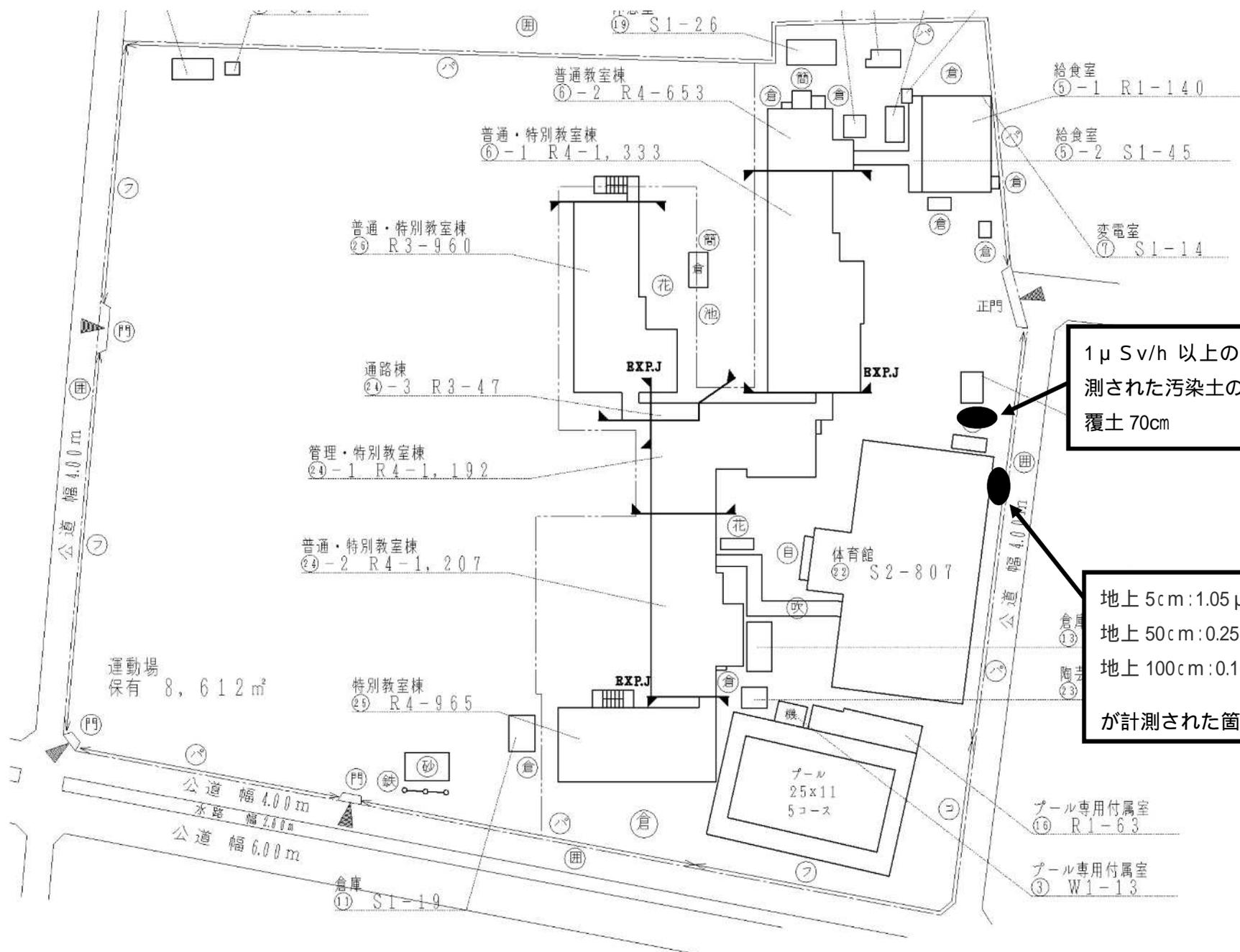
1  $\mu$  Sv/h 以上の放射線量が計測された汚染土の埋設箇所
