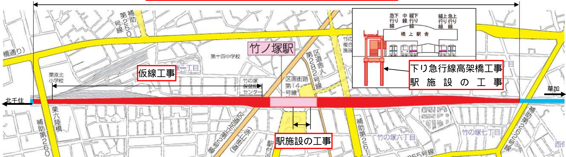
鉄道高架橋設計、仮設通路設置工事、下り急行線高架橋工事
