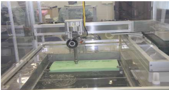
水圧でスポンジを切り取る様子
