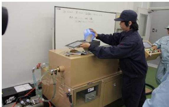
粉碎したペットボトルを機械にいれる様子
