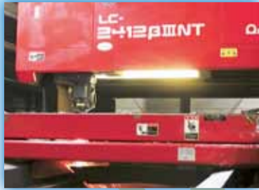
▶複合機(タレットパンチプレス機)による加工
