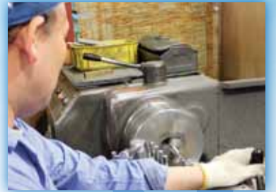
▶100分の1mm単位まで合わせる難削材の旋盤加工
