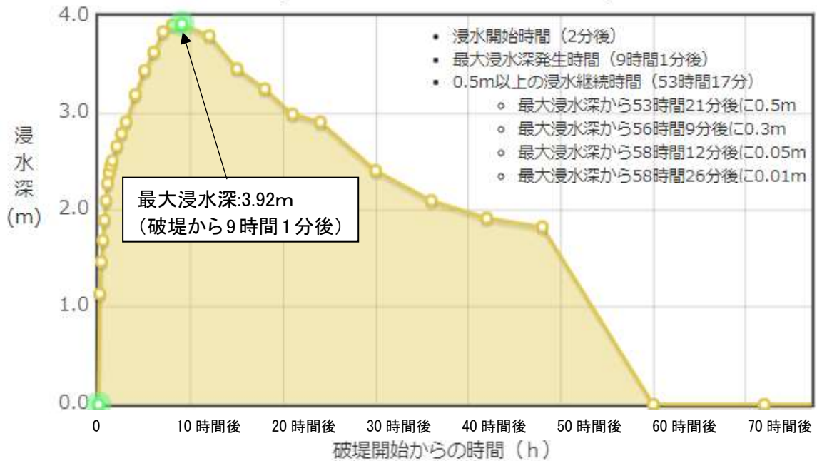
浸水シミュレーショングラフ (約70時間後まで) (BP175: 荒川荒川左岸 14.00k)
