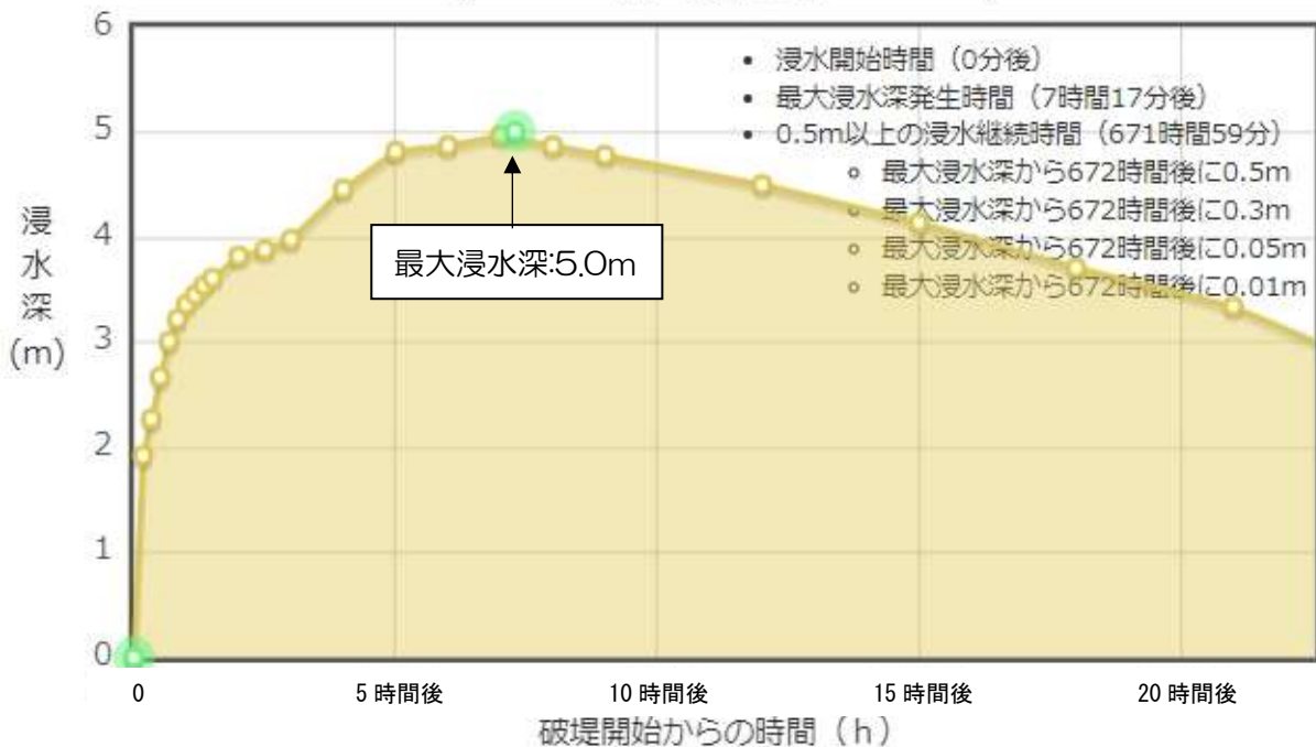
浸水シミュレーショングラフ（約20時間後まで） (BP276：荒川荒川右岸 13.75k)
